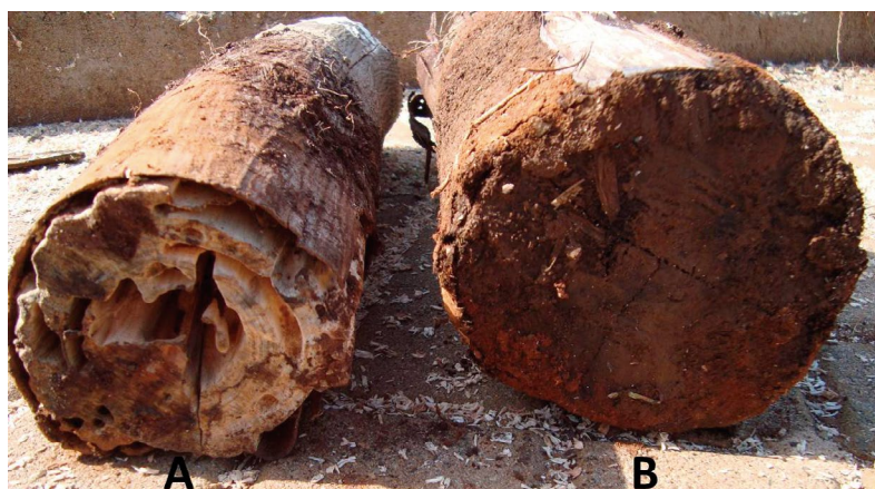
Figura 3. Amostras da parte subterrânea de moirões de Acacia mearnsii : (A) danos causados por cupins em amostras provenientes de dentro da mata nativa; (B) nenhum ataque nas amostras provenientes em área de pastagem.
